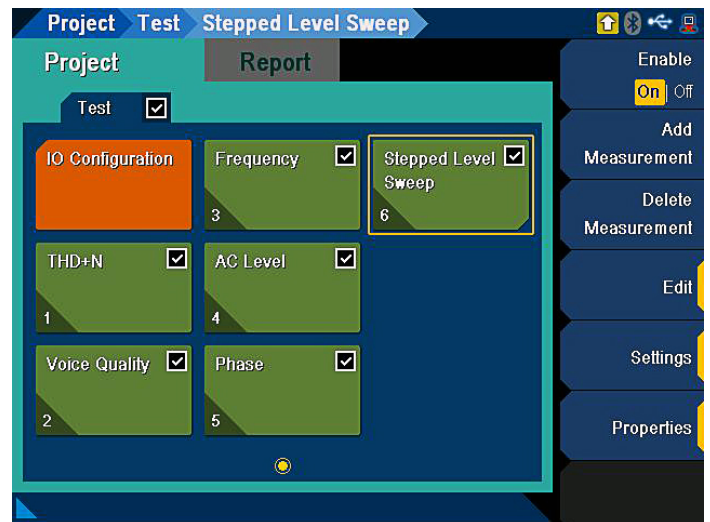
Рисунок 9. Функция управления последовательностью тестирования имеет подборку шаблонов измерений или позволяет самостоятельно выбирать наиболее часто используемые последовательности тестирования для проведения рутинных измерений
