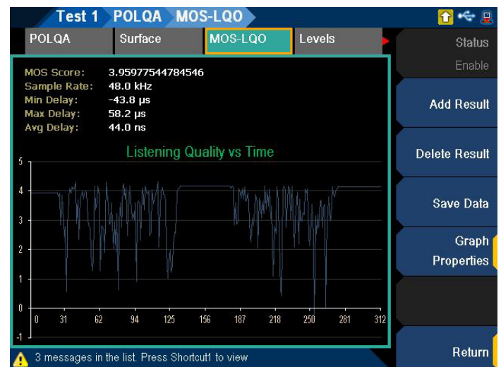
Рисунок 7. Средняя экспертная оценка качества речи (MOS) с указанием качества передачи речи для тестируемого устройства
