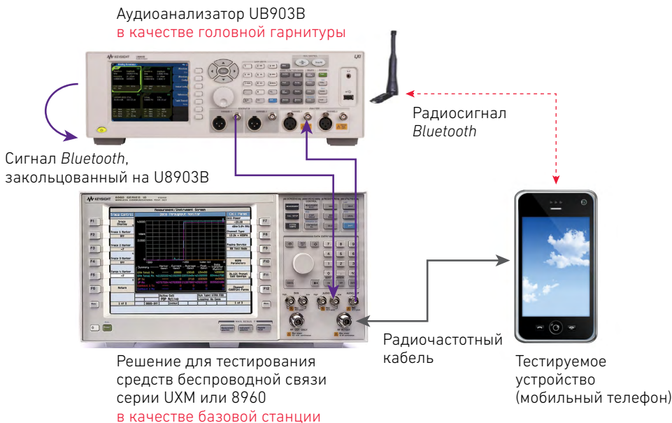
Рисунок 3. Пример тестирования передачи сигналов обратной связи – контроль качества аудиосигнала Bluetooth мобильного телефона.
