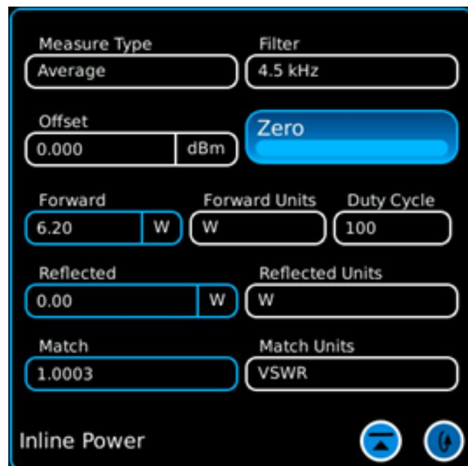
Окно встроенного линейного измерителя мощности
